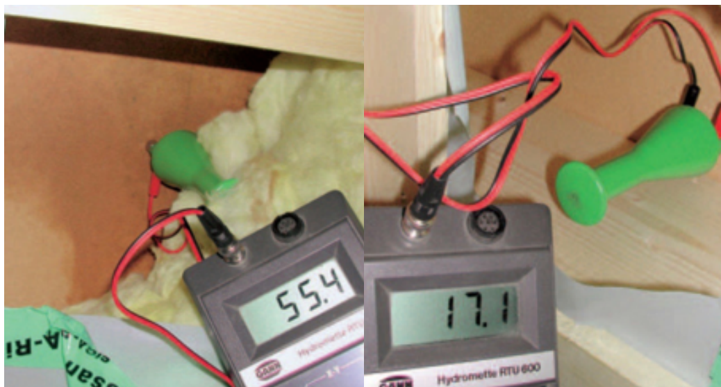
Figuur 5 - vochtmetingen achter de isolatielaag.
